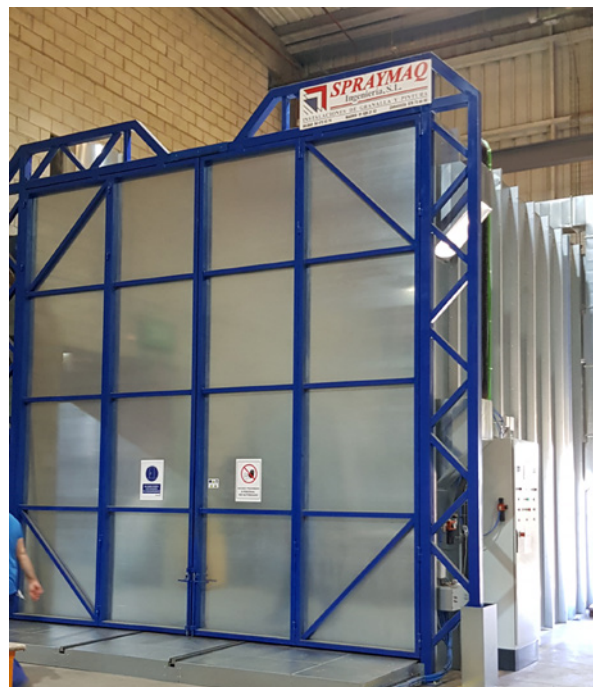
Megaplas. Cabina de proyección instalada.
