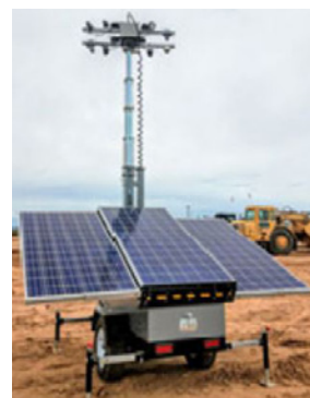
Torre de iluminación híbrida en la obra de la nueva pista del Aeropuerto de Dublín.
