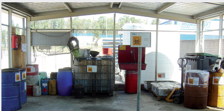
Almacenamiento de sustancias y residuos peligrosos.
