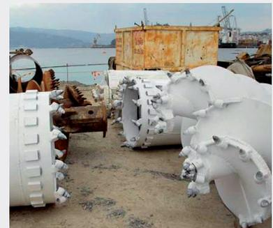
Herramientas especiales con dientes de widia para perforación a rotación del empotramiento en roca.
