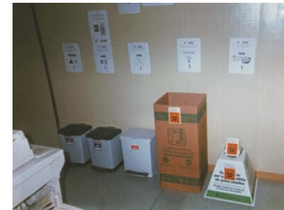
En las oficinas de obras también es preciso una sistemática para la correcta gestión de los residuos, complementada con señalización que indique al personal donde depositar los residuos que se vayan generando.
