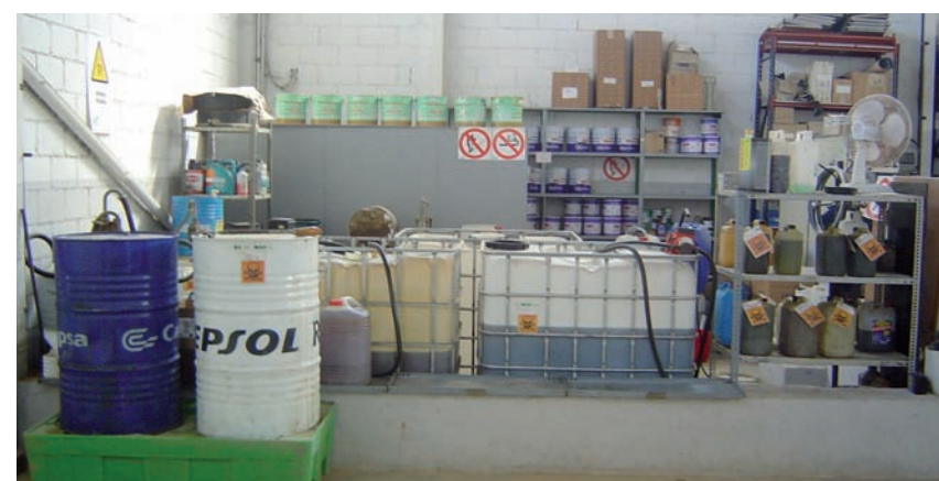
Es muy importante acondicionar zonas correctamente delimitadas y señalizadas para el almacenamiento temporal de residuos peligrosos, que deben permanecer cerradas cuando no se utilizan. Con esto se evitan derrames, vertidos y mezclas de residuos peligrosos.
