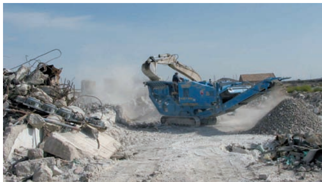
Una de las Buenas Prácticas adoptadas por FCC Construcción en el ámbito de los residuos es la valorización de escombros procedentes de demolición para formación de áridos que se emplearán como nueva materia prima.
