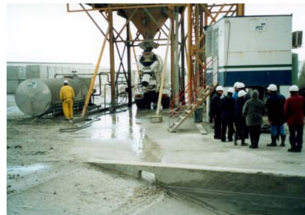
La impermeabilización de las áreas en que se producen lavados con aguas muy básicas, su recogida y decantación para la posterior utilización en la elaboración de hormigón, constituye también una buena práctica que evita el vertido contaminante y reduce el consumo del agua como recurso natural
