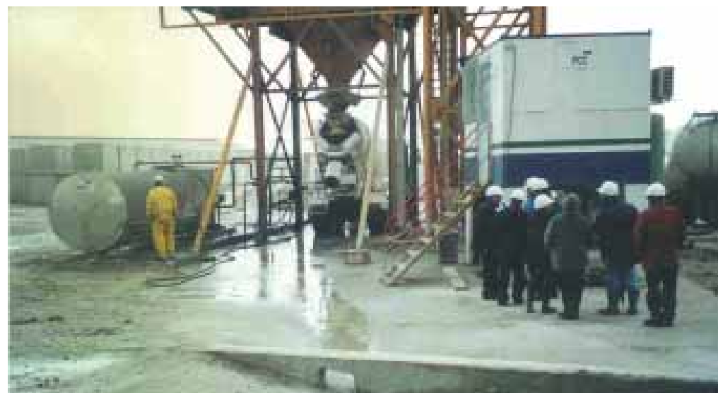
En las plantas de hormigón se instalan sistemas de recogida de las aguas de lavado que permiten su reutilización, evitando así el vertido de carga contaminante y ahorrando en el consumo de este recurso. (Planta montada para la construcción del Dique de La Osa, en Cantabria).
