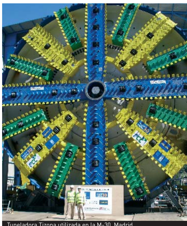
Tuneladora Tizona utilizada en la M-30, Madrid
